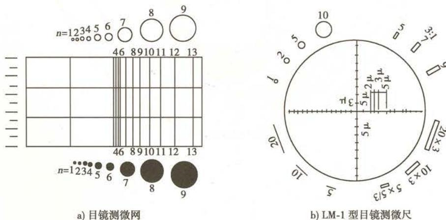
图 1 纤维观测用目镜测微尺
